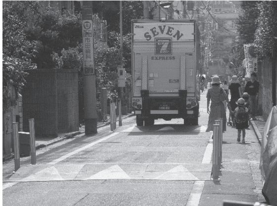
写真 4 ハンプ設置実験
