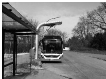
図6-2-2 架線充電式バス(左)と水素燃料バス(右)(筆者撮影)
