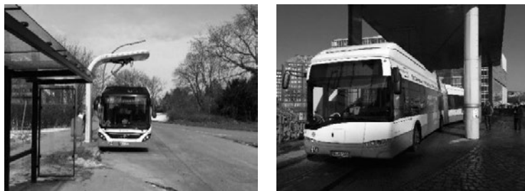
図6-2-2 架線充電式バス(左)と水素燃料バス(右)(筆者撮影)
