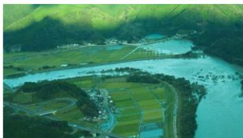
右側の写真では、右上の部分で、田んぼの中に水が入り込んでいるのが分かる。田んぼのエリアが、言わば遊水地として沈むが、水が引くと高いところから低いところへ水が流れるので、溢れた水も戻っていくというシステムで、これが伝統的に日本で行われてきた治水システムである。
